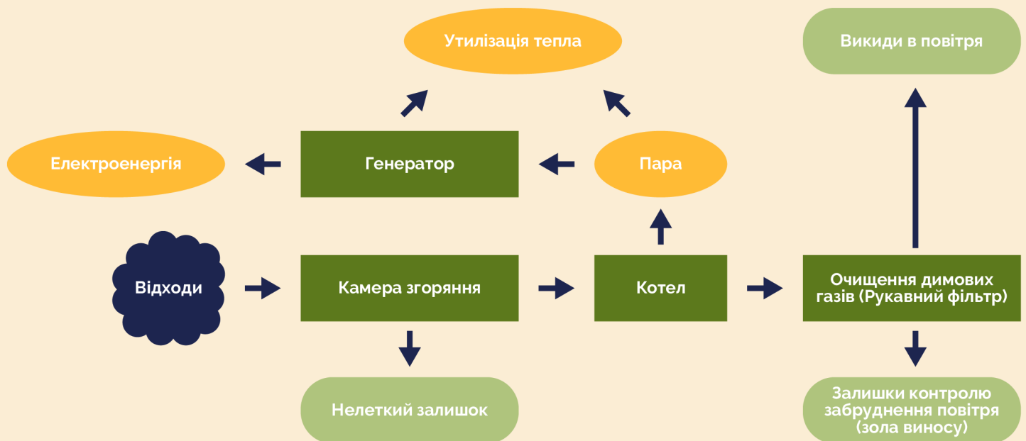
Рисунок 1 – Типова блок-схема сміттєспалювального заводу. Адаптовано з UNEP (2020)
